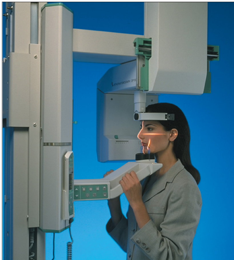
Figura 11 – Guide di posizionamento; si noti il morso, le guide per la testa e la luce di posizionamento
